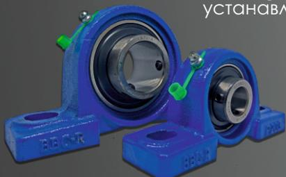
Уплотнение усовершенствованной конструкции с лабиринтом между листовым элементом и резиновой кромкой, в сочетании с защитной крышкой модификации **AGRO-SHELL-HB** обеспечивают максимальный уровень защиты без потерь эксплуатационных характеристик.
